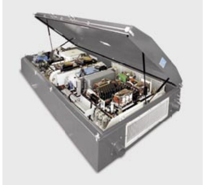
Dachgerätegehäuse mit geöffneter Haube Roof-mounted equipment enclosure with open cover
